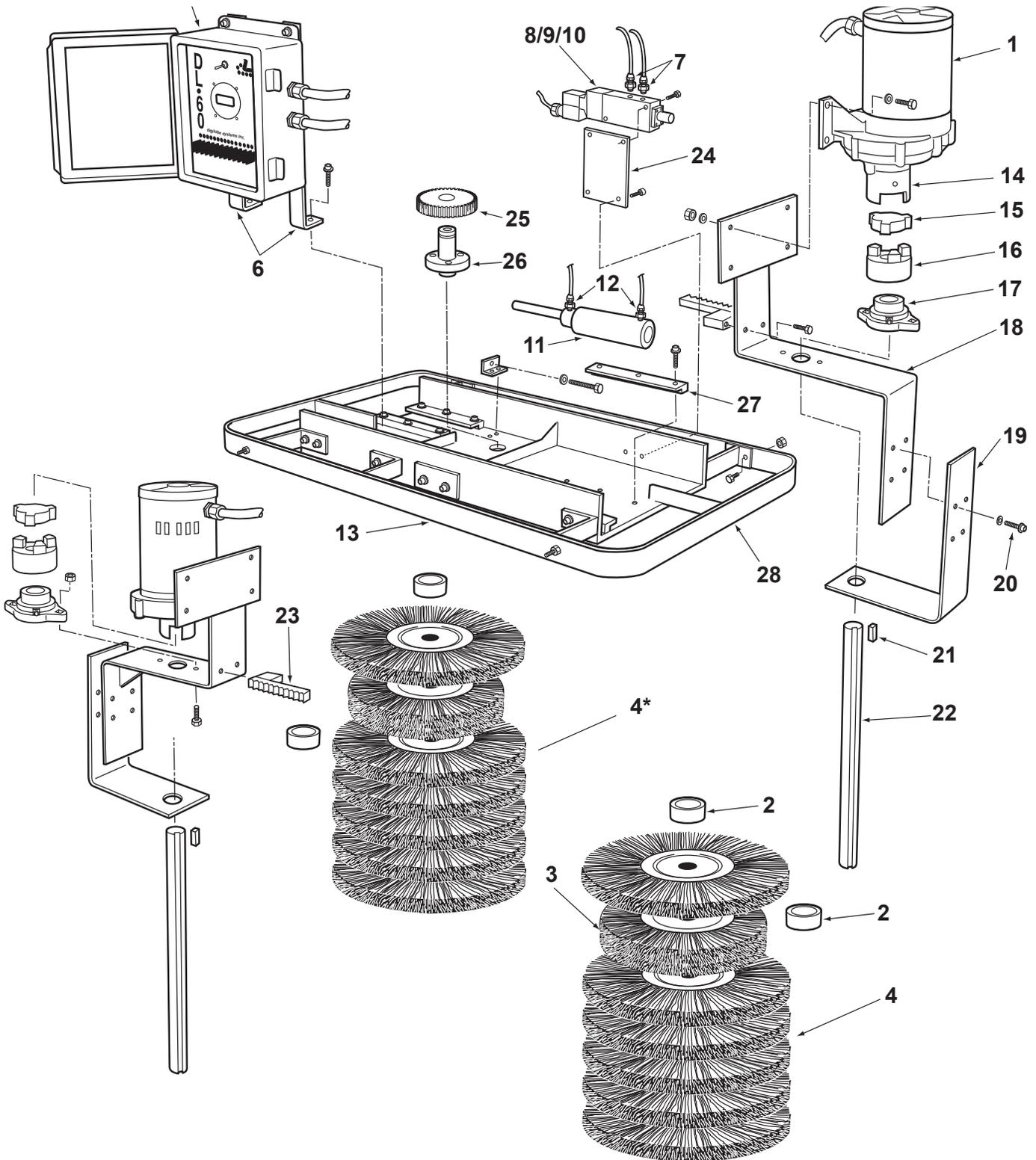
El DL-60 Power Chain y Trolley Cleaning System de Digilube Systems son accionados por motores gemelos de engranaje directo para proveer el máximo torque sin tener que usar una cadena, correa, piñón o polea. Esta unidad está diseñada para remover y prevenir la acumulación de pintura, tierra, sarro, y polvo en las cadenas del transportador y carretillas.
