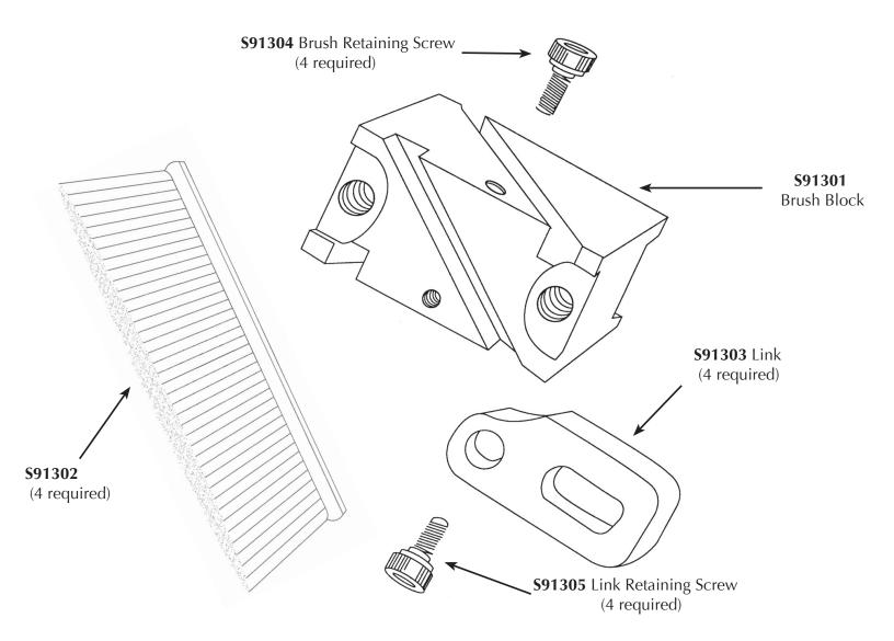
BRUSH SHOULD BE SET-UP BY ALIGNING SCORE MARKS ON BRUSH WITH EDGES OF BRUSH CAVITY
